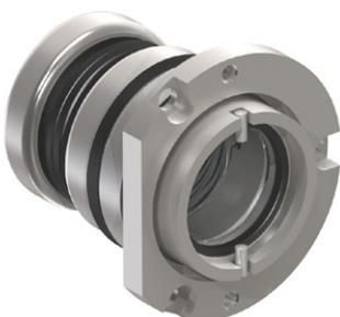
Die doppelwirkende entlastete Gleitringdichtung in hygienischer Cartridge-Bauweise ist die ideale Lösung für Anwendungen mit niedrigen Drehzahlen und viskosen Produkten und hohen Drehzahlen während des CIP-Prozesses.
