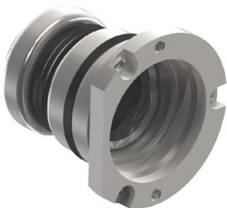
Die einfachwirkende entlastete Gleitringdichtung in hygienischer Cartridge-Bauweise wird als Standarddichtung bei Anwendungen mit niedrigen Drehzahlen und/oder niederviskosen Produkten eingesetzt.
